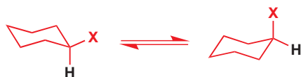
单取代环己烷的环翻转 注意氢原子在直立到平伏的转换过程中变化
